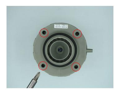
2. Öffne das Gerät vorsichtig und wechsle die vier Batterien vom Typ C LR14 Alkaline 1.5V. Schraube die Abdeckung wieder an der Unterseite an.
