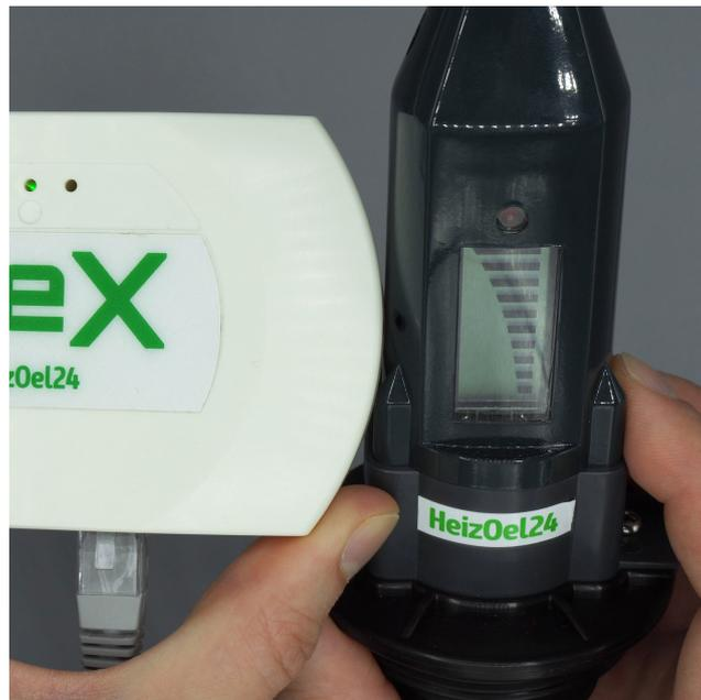
4. Zeigt dir das Display eine Zapfpistole an, sind der Empfänger und der Sender erfolgreich gekoppelt.
